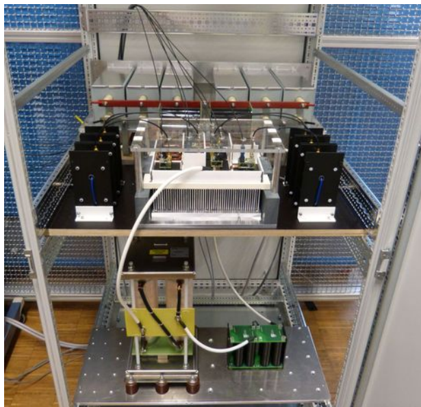
Versuchsaufbau des einphasigen Hochspannungs-Stacks. Bild: Fraunhofer ISE
