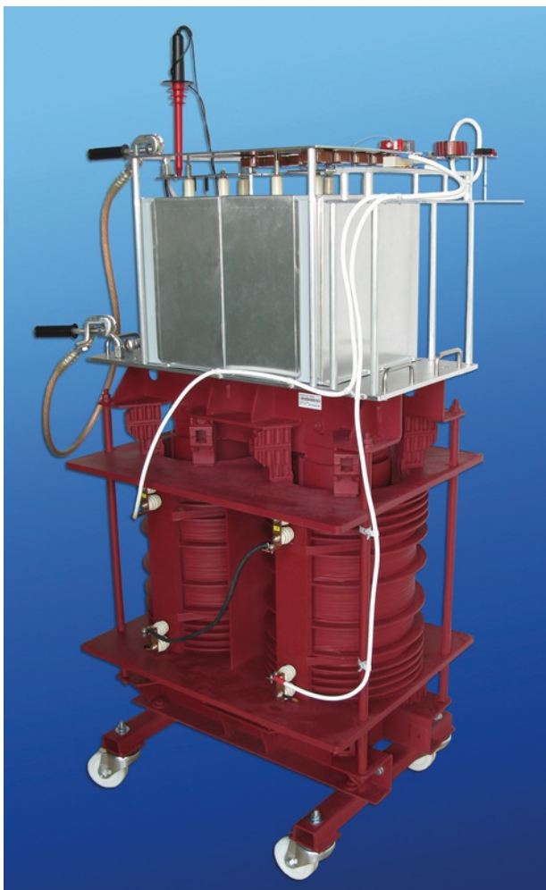
Teststand zur Bestimmung der Schaltenergien von Hochvolt-Transistoren bis 20 kV. Bild: Fraunhofer ISE
