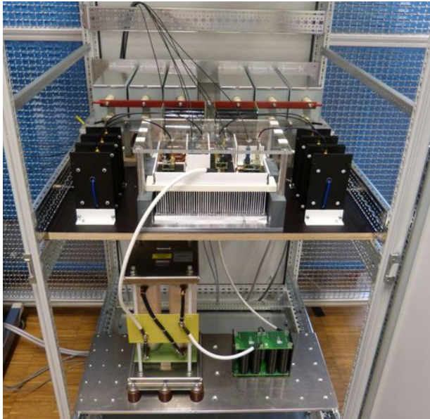
Versuchsaufbau des einphasigen Hochspannungs-Stacks. Bild: Fraunhofer ISE
